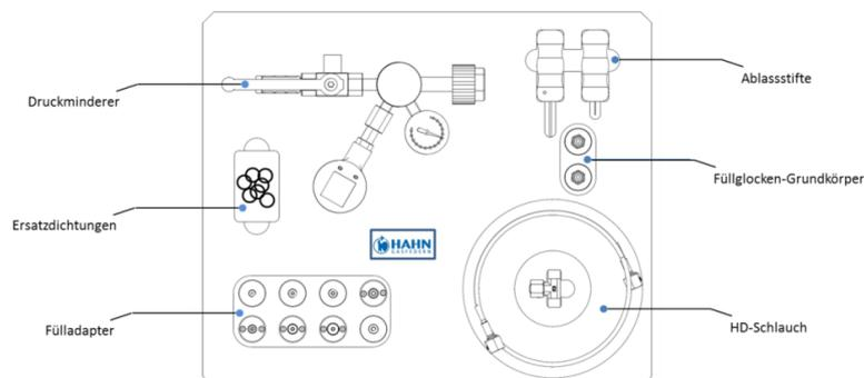
Bitte beachten Sie, dass Sie zum Befüllen Ihrer Gasfedern, neben unserem Füllkoffer, noch eine Stickstoff Gasflasche mit Flaschenventil Din 477 Nummer 10, Reinheit 5.0 benötigen.
