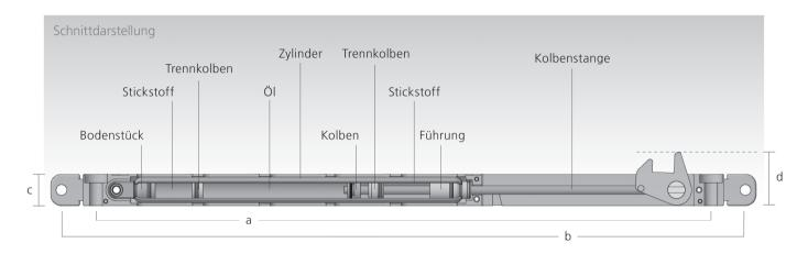
HAHN Gasfedern präsentierte 2015 eine neue Produktfamilie für das Dämpfen und Schließen von Schiebetüren und anderen Anwendungen mit linear bewegten Massen von ca. 40–400 kg.
